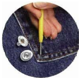
3. Punzón perforador: para hacer agujeros en diferentes materiales con el fin de insertar hilos o hacer botoneras.
